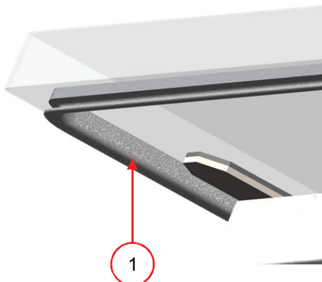
Rys. 15: Wymiana uszczelki pokrywy
